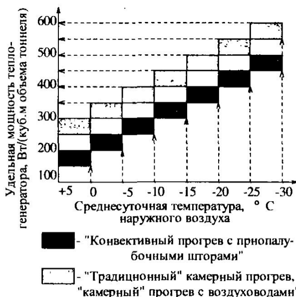
Рис. 7.4. Предварительный выбор теплогенератора
